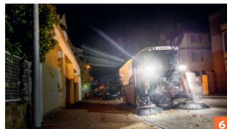
Die Maschine verfügt über eine Lithium-Ionen-Batterie, sodass keine lokalen CO<sub>2</sub>-Emissionen anfallen. Zudem hat die neue Kompaktkehrmaschine das bewährte Wasserrecyclingsystem an Bord, das für einen sparsamen Einsatz von Frischwasser sorgt. Der Geräuschpegel liegt deutlich unter dem für Nacharbeiten geltenden Grenzwert von 98 dB (A). Da die Maschine an dem erprobten Konzept der konventionell betriebenen Variante MC 250 ansetzt, bietet sie Anwendern einen komfortablen, ergono-
